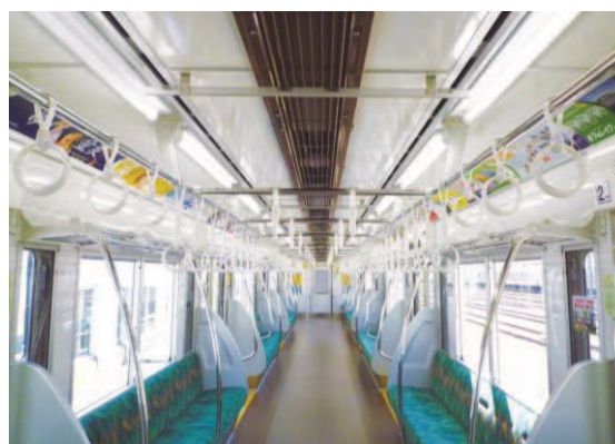
《LED照明を導入した車両室内》
