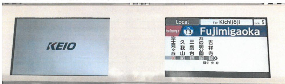
《2画面化したドア上の液晶ディスプレイ 左:コンテンツ、右:運行案内》
