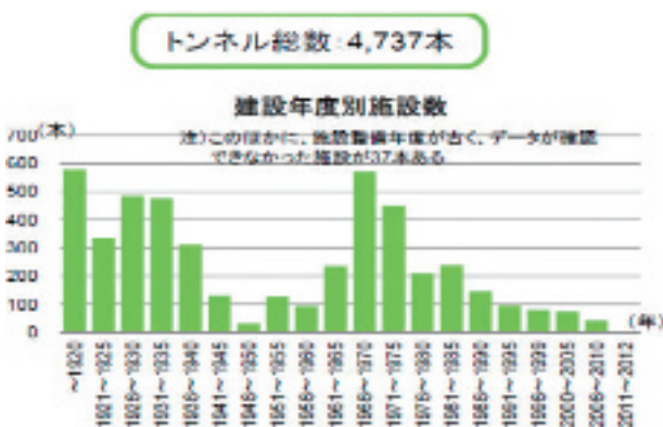
図-1 鉄道トンネルの建設年度別本数※1
