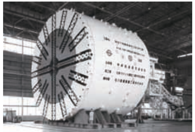
写真-19 世界最大の抱き込み式親子泥水シールド (面板中央の着色部分が複線断面)
