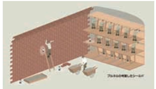
図-1 ブルネルの考案したシールド
