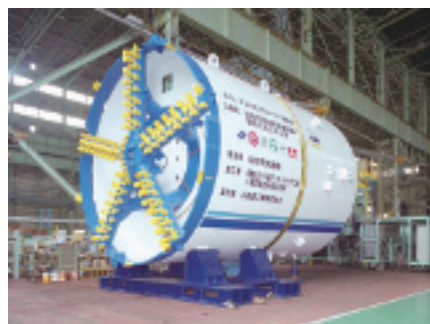
卸町工区のシールド機
