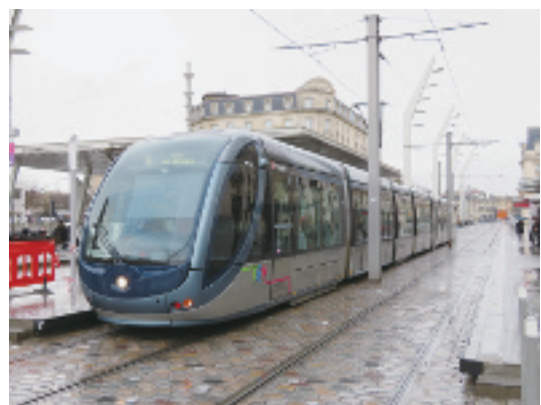
写真－32 サン＝ジャン駅前に停車する路面電車。この区間は架空線集電なのでパンタグラフが出ており、路面には地表集電用の第三軌条はない。（北を見る。2020年1月30日）
