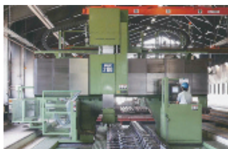
写真-4 マシニングセンタ（門型ガンドリータイプ）
