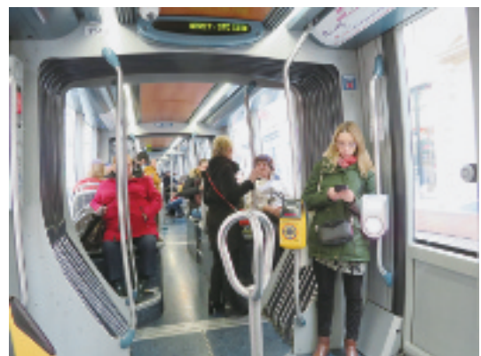
写真－35 シタディス型低床路面電車の車内。切符の有効化器械とICカードの読取機が設置されている。7車体連節式である。（2020年1月30日）
