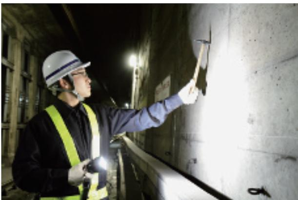
写真-2-6 トンネルの打音検査
