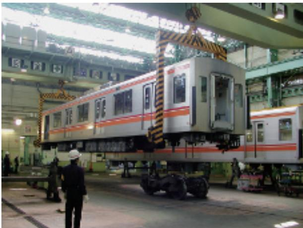
写真-2-3 工場で台車と車体を分離しての検査
