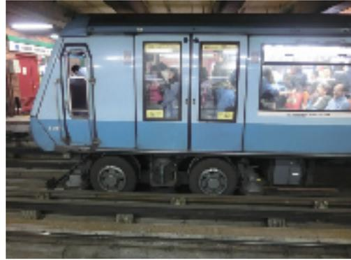
写真-13 メトロ5号線パケダノ駅に停車するゴム=タイヤ式電車。窓が広い。（2015年11月18日）
