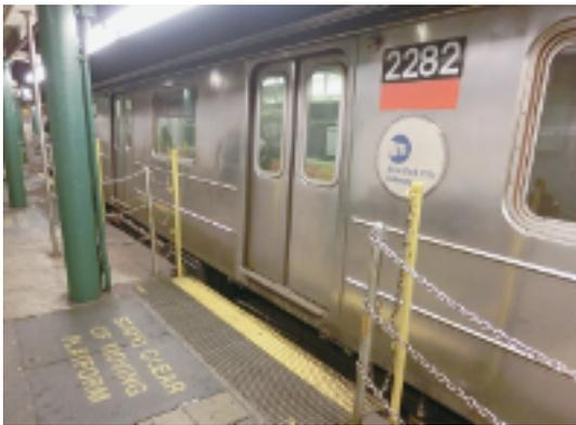
写真-17 サウス=フェリー (South Ferry) 駅の可動式ホーム。電車の到着時には、ホームとの間に間隔がある。(2014年1月13日)
