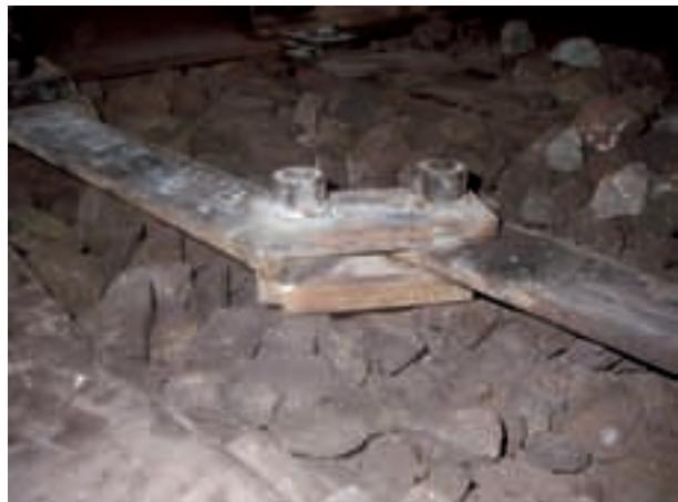
写真2 変形したゲージタイの絶縁部
