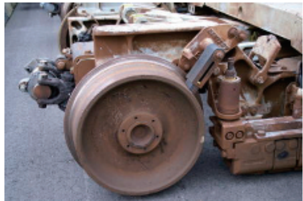
車輪踏面に向けて付けている HPF 個体摩擦調整材
