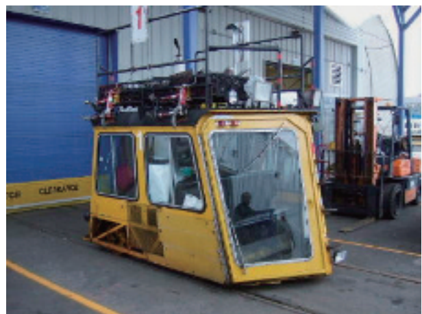
保線車両の例（軌道点検車両）
