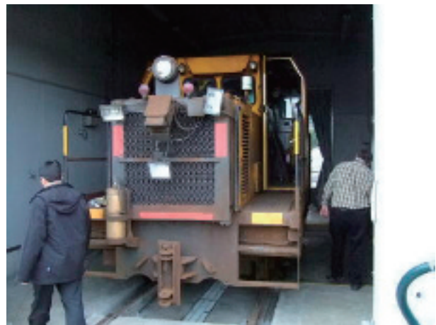
HHT 社の 8 頭式レール削正車
