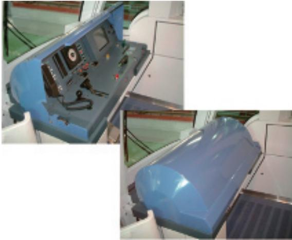
写真-4 運転台機器に開閉式カバーを設置
