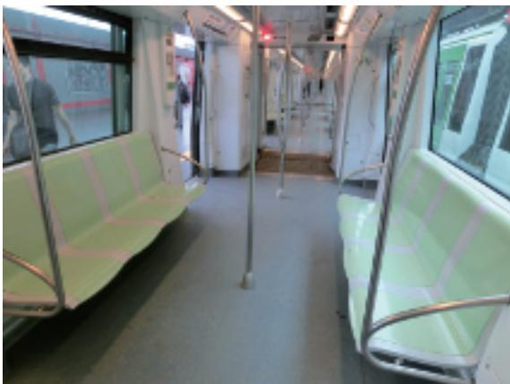
写真-38 メトロ1号線では、FRP製の4人掛けロングシートを使用し、乗客の座る位置が明示してある。(ビジャ=エル=サルバドール駅。2015年11月22日)
