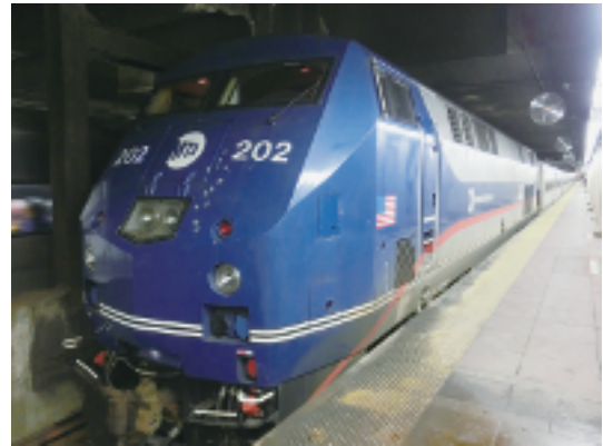
写真-3 グランド=セントラル駅の地下ホームに停車するGE社製ディーゼル・電気両用機関車が牽引する旅客列車。(2014年1月12日)
