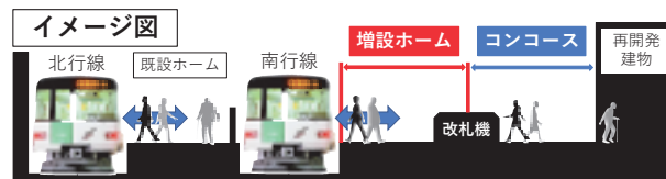
ホーム増設後の南北線さっぽろ駅
