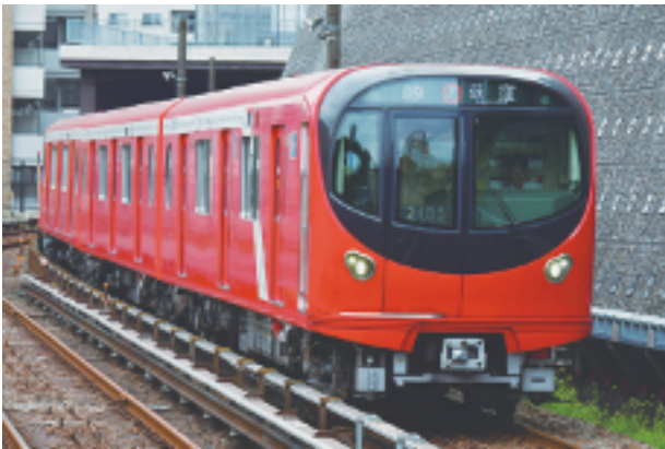
東京メトロ丸ノ内線で自動運転に供用される2000系電車。2019年7月から営業運転を開始。一部に採用された丸窓(円形の窓)がデザイン面のポイントといえます
