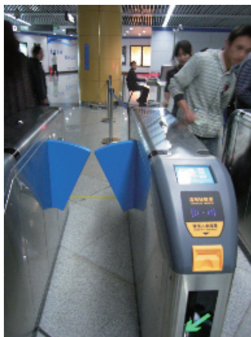
天府広場駅出口用自動改札機 （下の黄色い部分は、1回限りのICカード返却口）
