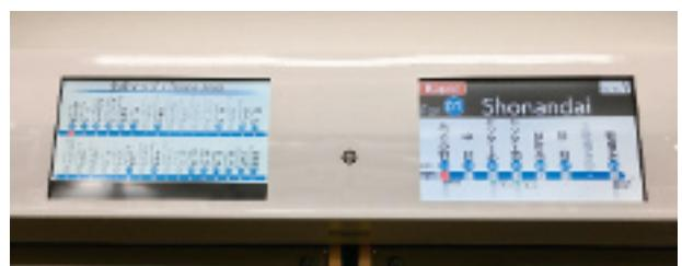
写真4 液晶式車内案内表示装置 (3000V形)
