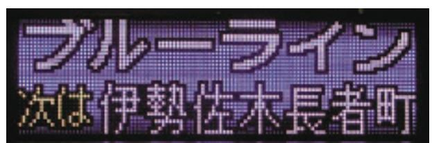
写真5 側面車外案内表示装置 (ブルーライン)
