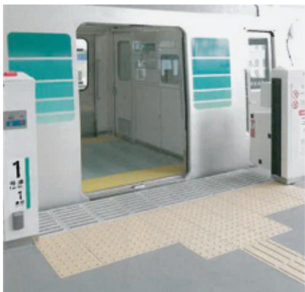
写真7 ホームと車両床面の段差（グリーンライン）
