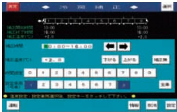
図4 車両空調温度設定変更 (TIS画面)
