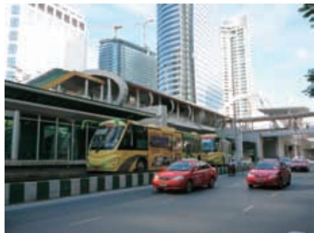
写真-32 バンコクのBRTシステム。一般車道とBRT専用車線の間には、停留所付近では高さ約50cmの分離壁が設けられている。(サトーン停留所。2011年8月6日)
