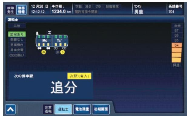
図13 モニタ表示器架線認識状態
