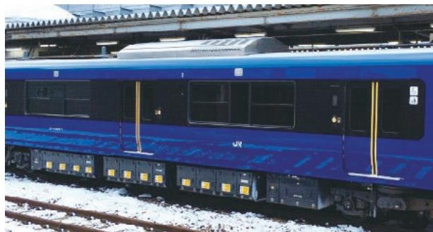
図4 Tc' 車床下機器配置
