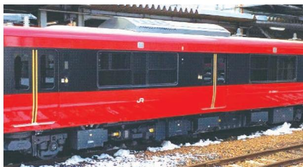
図5 Mc車床下機器配置
