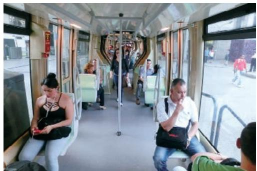
写真-24 ゴムタイヤ式のトランビアの車内は低床式の路面電車とほぼ同じである。(2016年9月27日)
