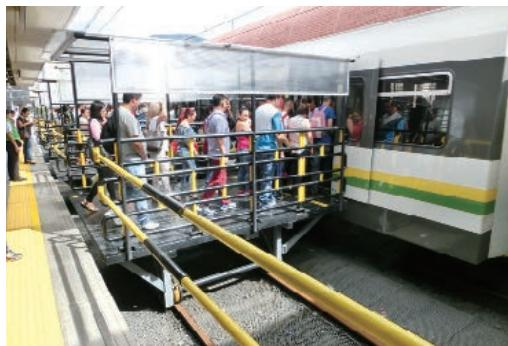
写真-19 メトロB線のサン=アントニオ駅は相対式2面2線であるが、南側の線路しか使用してなくて、北側のホームから乗車する際には、北側の線路の上に置かれた移動式台車（ドア付近のみ）から乗車する。(2016年9月27日)
