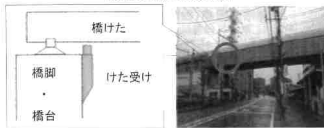
落橋防止工による橋梁の耐震対策
