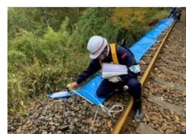
路盤の流出状況の測定
