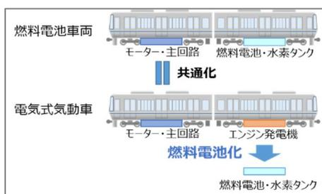
例：汎用型燃料電池・水素貯蔵システム
