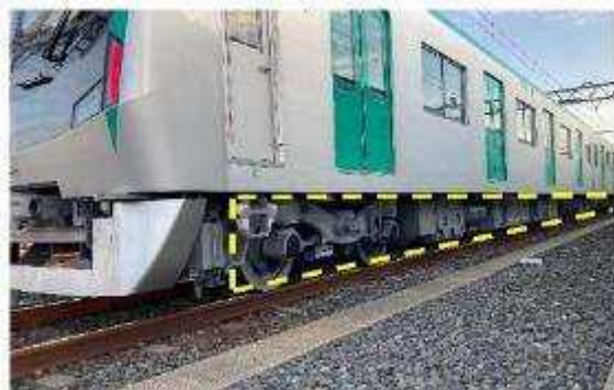
床下の制御装置やモーター
