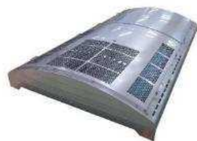
冷房装置（屋根上に設置）
