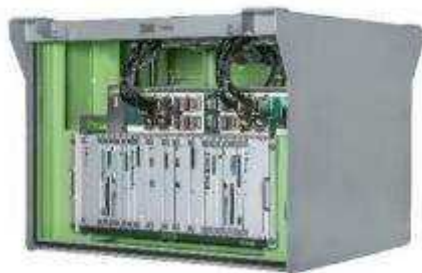
自動列車運転装置（送受信部）
