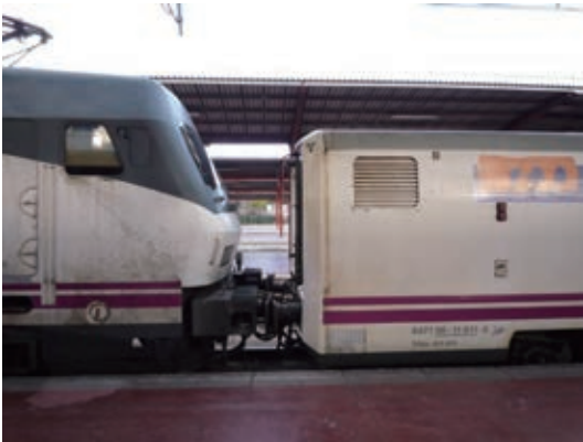
写真-2 左が先頭の電気機関車、それに連結されているタルゴ客車（右）。タルゴ客車は、車高が低く（重心が低い）、車両長も短い。（東を見る。2013年3月28日）
