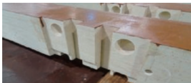
合成橋まくらぎの底面加工
