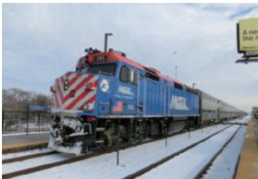
写真－7 Jefferson Park駅14時1分発のMetraの列車。奥が先頭の制御客車側、手前の最後尾のディーゼル機関車が後ろから押す推進運転（動力車が編成の先頭にない運転方式）である。客車は2階建てのギャラリー＝カー（Gallery-style car）。（シカゴの都心方を見る。2014年1月19日）
