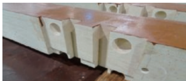
合成橋まくらぎの底面加工
