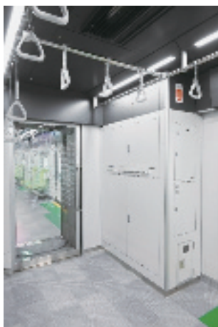
天井高機器室
