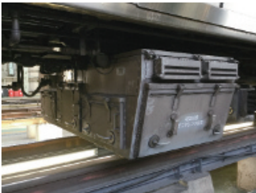
写真-3 軌道材料モニタリング装置
