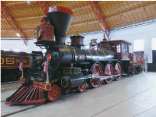
写真-8 1863年にB & Oマウント=クレア工場で作されたNo. 147 “Thatcher Perkins (サッチャー=パーキンス)”号。2003年2月に扇形庫の屋根の崩壊により被害を受けたが、2010年に修復された。車軸配置は4-6-0 (2軸先輪+3軸動輪: ホワイト式分類)である。アメリカでの愛称は“Ten Wheeler”である。(2014年1月16日)
