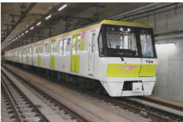
大阪メトロ長堀鶴見緑地線の主力車両・70系電車。日本初の鉄輪式リニアモーターカー（リニアメトロ）として1990年に開業。現在の路線は大正～門真南間15.0km。2011年以降、更新工事を施工されています（画像・大阪メトロ）
